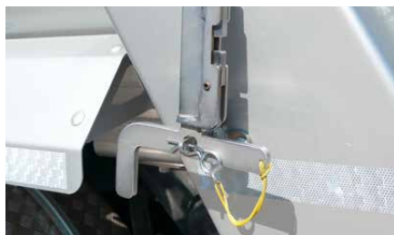
Hinterkipper mit flachbauender Kurbel.
