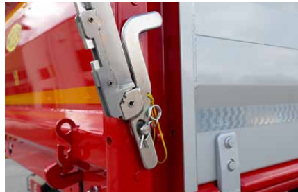
Gesetzeskonformer Betrieb: Mit der flachbauenden Kurbel wird die maximale Außenbreite eingehalten.
