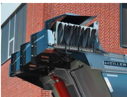
Planenschutzdach schützt beim Beladen
