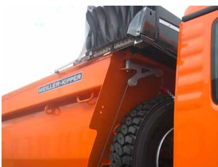
Hinterkipper: Kombinierbar mit Ersatzrad an der Stirnwand.
