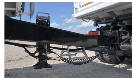
Überstieg an der Deichsel mit Haltegriff am Stützfuß erleichtert das Öffnen und Schließen der seitlichen Rollplane am Zentralachsanhänger.
