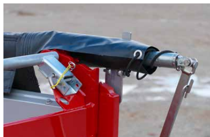
Klappbares Laufrohr verhindert Beschädigungen.
