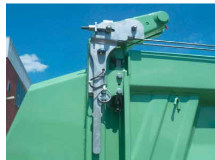
Dreiseitenkipper: Seile abnehmbar durch Schnellverschluss.
