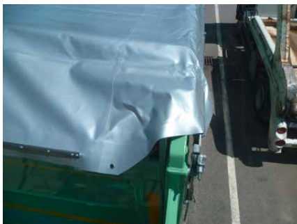
Dreiseitenkipper: Plane deckt Rückwandlager vollständig ab.
