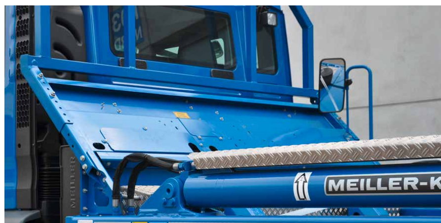
Schutz für Fahrer und Fahrerhaus: MEILLER Stirnwand in verschiedenen Ausführungen
