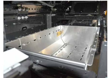
Raum optimal genutzt: Ausziehbarer Netzkasten zwischen den Achsen.
