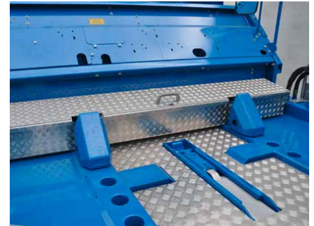
Große Staukiste mit abschließbarem Deckel, quer hinter dem Bordrahmen angebracht.
