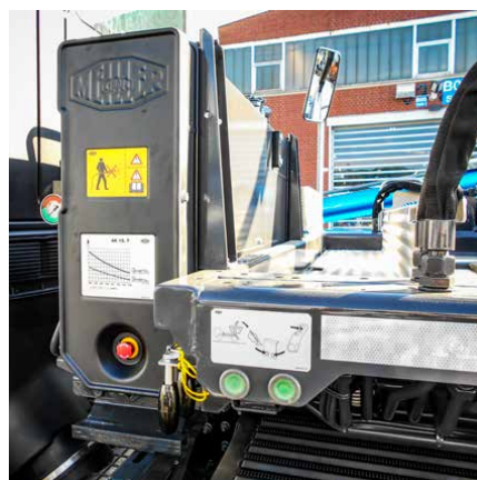
MEILLER Steuereinheit mit integrierter Überladungs-Kontrollanzeige (Serie bei Teleskopausstattung)
