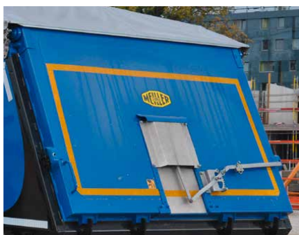
Szczelne zamknięcie i idealne dozowanie dzięki zbożowemu szybrowi.
