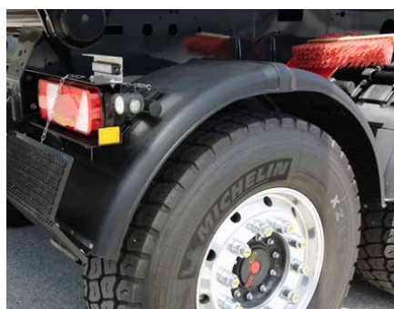
Podnoszone chlapacze i solidne mocowanie nadkoli to konieczność na placu budowy.
