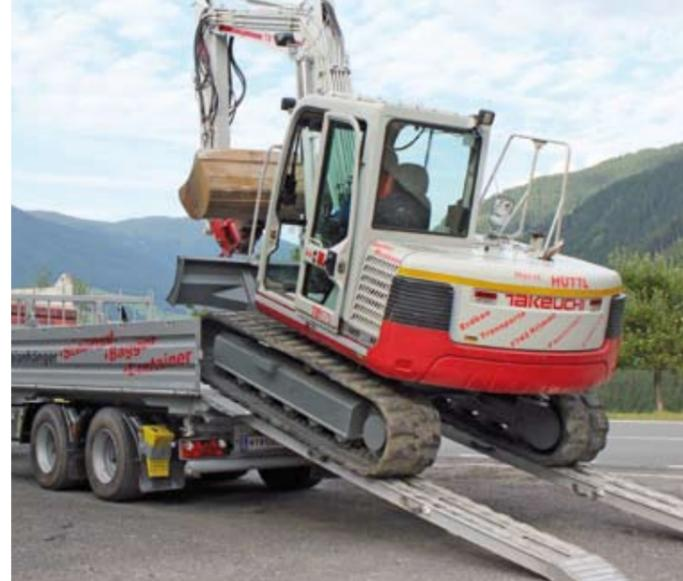
Aluminium Laderampen unter der Kipperbrücke erleichtern das Auf- und Abfahren der Bagger.
