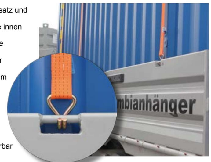
Das von Meiller zum Gebrauchsmuster angemeldete Bordwandzurrösesystem, mit zusätzlichem Bodenblech und Stirnwandzurrösen, ermöglicht das Verzurren von Teilen über 2420 mm, ohne dass der Gurt über die Bordwand gezogen wird.
