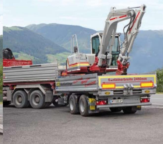
Überstellungen von Baggern werden durch die Baggerverriegelung an der Stirnwand und 8 Tonnen Bodenblechzurrösen ermöglicht.
