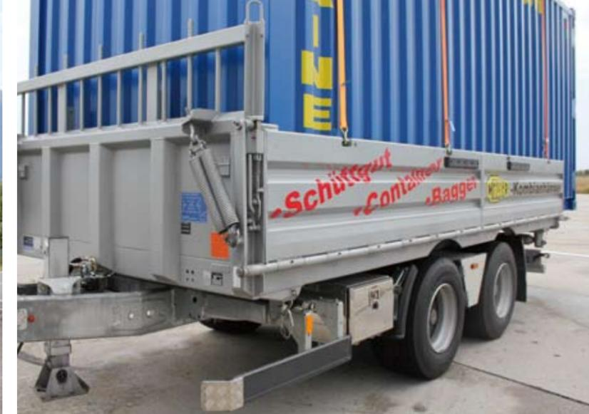
Innenbreite 2460 mm und Bordwandzurrösesystem für einfachen Containertransport
