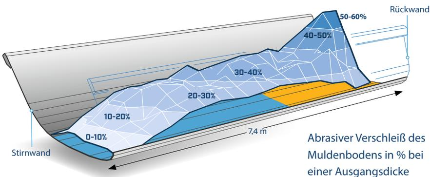
Abrasiver Verschleiß des Muldenbodens in % bei einer Ausgangsdicke von 5 mm und einer Muldenlänge von 7,4 m
