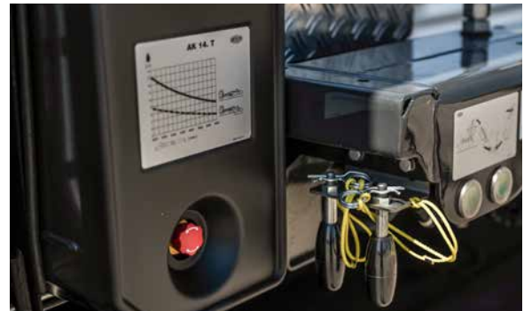
MEILLER Steuereinheit mit integrierter Überladungs-Kontrollanzeige.
