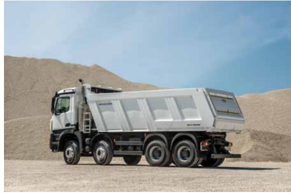
Hinterkipper MAXTREME mit eckiger Muldenform.
