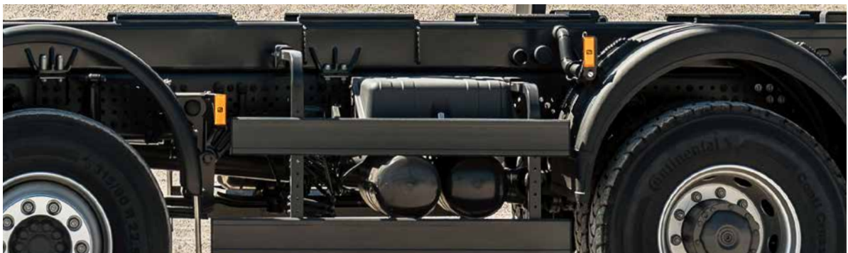
Optimaler Korrosionsschutz durch KTL-grundierte und zusätzlich decklackierte Stahlbaukomponenten.
