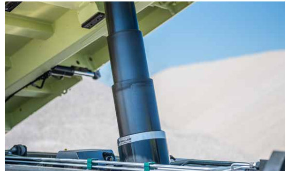
Nur ein Hydraulik-Teleskopzylinder beim 4-Achser
