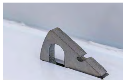
Œillets escamotables, rabattables dans le fond les produits en vrac n'accrochent pas (force 2 t).
