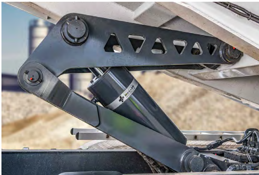
Un design moderne et encore plus léger : Le nouveau système de compas
