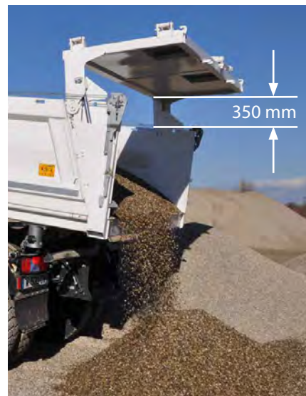
Grande hauteur de passage lors du bennage arrière avec la porte arrière hydraulique
