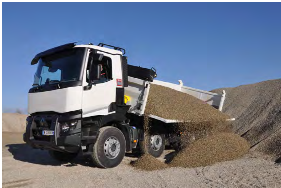
Bordmatic avec angle d'ouverture à 90° : La marchandise en vrac est déchargée loin du véhicule.
