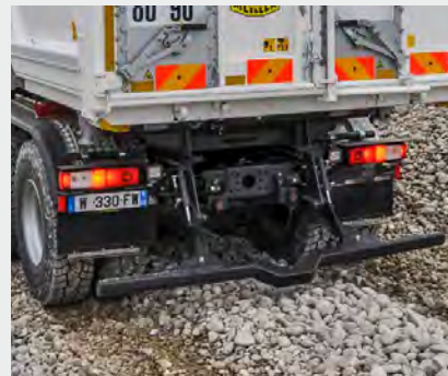
Robuste et optimisé en poids : L'anti-encastrement MEILLER en tube
