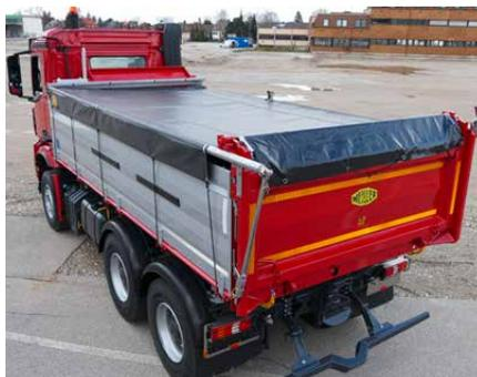
MEILLER Bâche latérale à enroulement à commande à partir d'en bas par manivelle.
