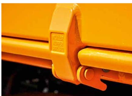
Crochets de bâche intégrés sur le fond de la caisse basculante
