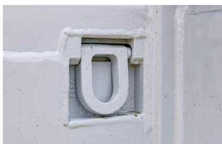
Des anneaux d'arrimage dans la ridelle avant retiennent le chargement vers l'arrière (1 t de force d'arrimage).
