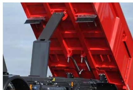
MEILLER производит стабилизатор типа «Ножницы», обеспечивающий надежность в любом положении
