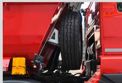
Держатель запасного колеса на передней стенке
