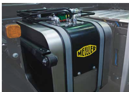
Alles aus einem Tank: Mehrere Verbraucher (Kipper, Kran & Kommunalhydraulik) können aus einem MEILLER Kompakttank versorgt werden.
